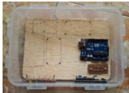
Gambar 3.7. Pemasangan Arduino UNO dan Jumper
