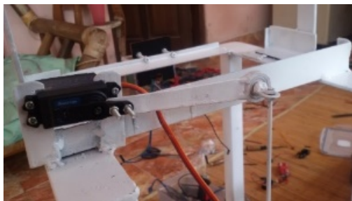
Gambar 3.10. Pemasangan Motor Servo
