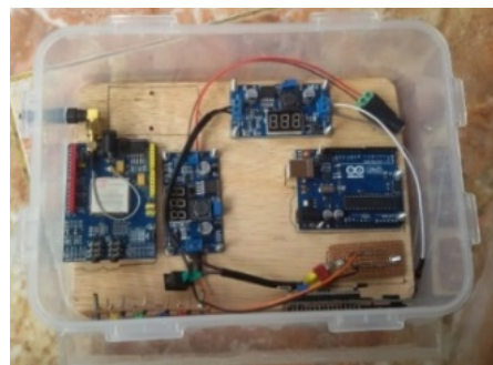
Gambar 3.8. Pemasangan SIM 900 dan Buck Converter
